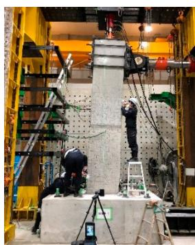
大型RC柱模型の載荷実験
