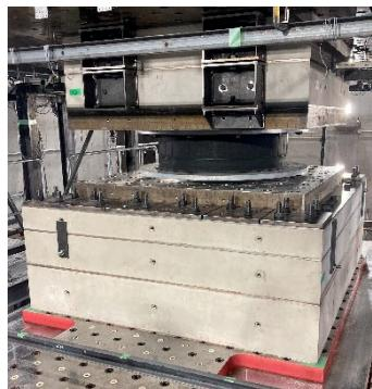
実大免震支承(φ1200mm)の載荷実験
