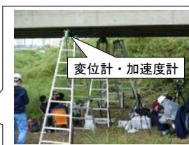
変位計測や加速度計測からたわみ振動特性を把握し
