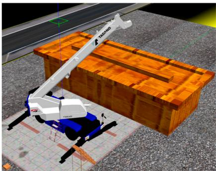
建設現場を再現したシミュレータの様子。クレーンのブーム先端に鉛直下向きにカメラを設置しています。
