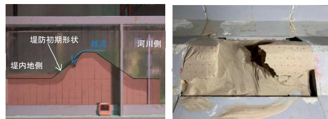
1次元水路による堤防横断面の破堤実験（左）と
