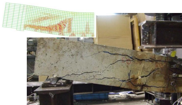
図-3 鉄筋腐食 RC はりの載荷実験および有限要素解析結果
