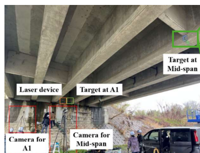
レーザー光と画像計測を用いた変位計測手法の現場実験
