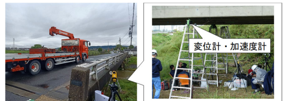
変位計や加速度計から振動特性を収集し 構造物の健康状態をチェックする
