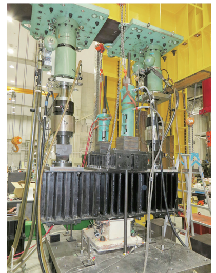
40年供用された支承の性能確認実験
