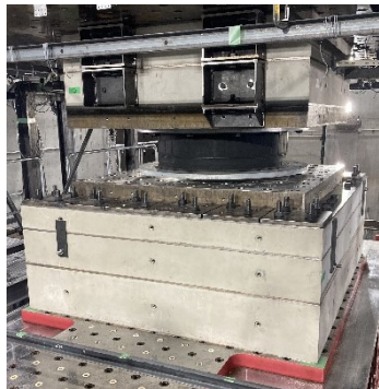
実大免震支承(φ1200mm)の載荷実験
