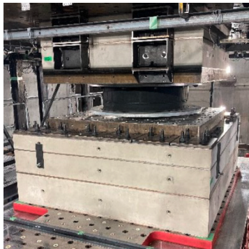
実物免震支承(φ1200)の荷重実験
