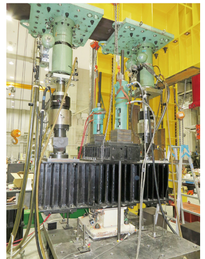
40年供用された支承の性能確認実験
