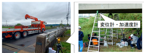
変位計や加速度計から振動特性を収集し構造物の健康状態をチェックする
