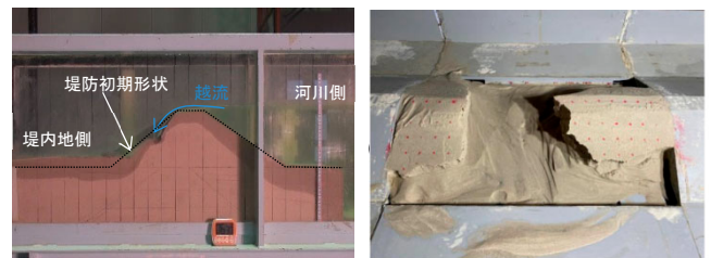
1次元水路による堤防横断面の破堤実験（左）と河川の流下方向を考慮した2次元氾濫台での破堤実験（右）
