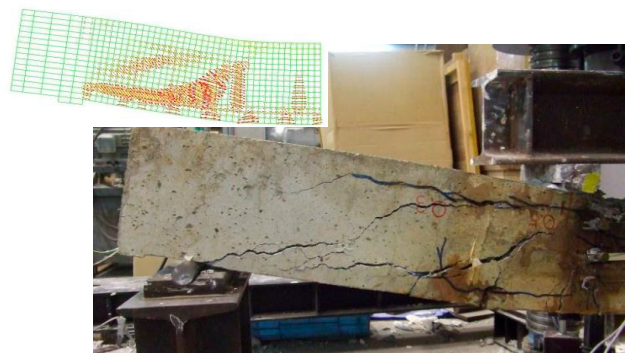
図-3 鉄筋腐食 RC はりの載荷実験および有限要素解析結果
