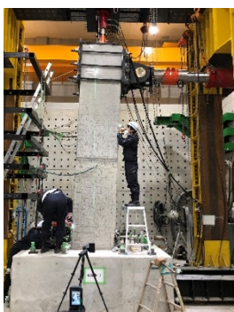
大型RC柱模型の荷重実験
