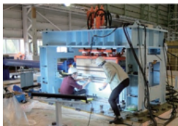
図1 大型2軸剪断摩擦試験機 (防災科学技術研究所所有)
