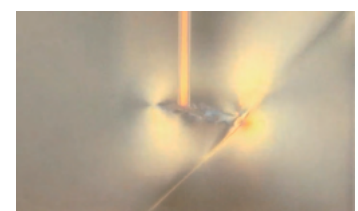
図5 光弾性により可視化された 断層面にかかる応力
