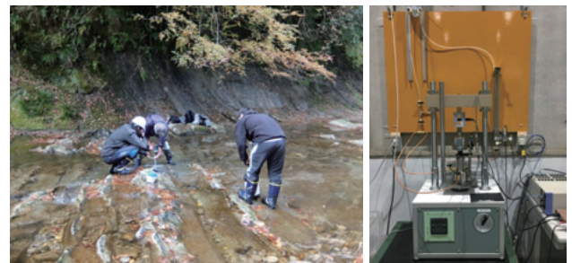
図3 岩石試料のサンプリングの様子(左)、圧密試験機(右)
