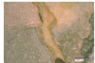
図4 粘土により閉塞した花崗岩の亀裂 画像の幅は0.5mm 高さは0.375mm
