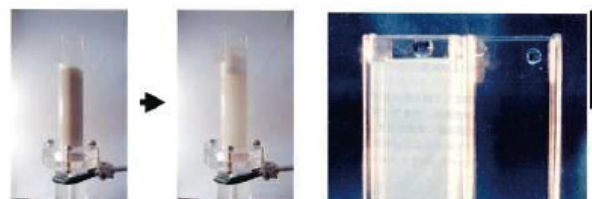
(左)新規分離技術(マイクロバブル浮選)の光景 (右)浮選前後の溶液の様子、左が浮選前
