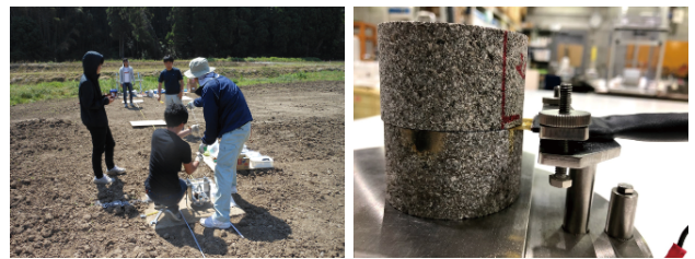
図3 熊本地域の掘削孔における温度の深度分布の計測風景(左)、岩石コア試料を用いた熱物性の計測例(右)
