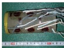
図2 応力計測に用いた岩石コア試料
