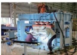
図1 大型2軸剪断摩擦試験機
