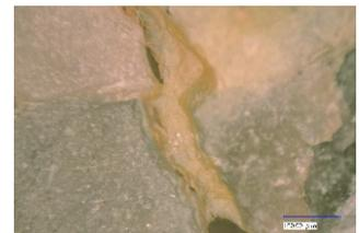
図4 粘土により閉塞した花崗岩の亀裂
